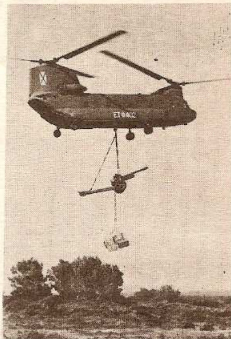
El helicóptero pesado "Chinook" transporta, en carga exterior, una batería.
